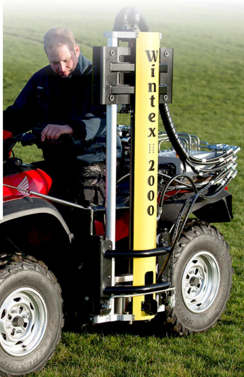
Das Wintex 2000 entnimmt hochqualitative Bodenproben in jeder Bodenart. In nur einem Arbeitsgang werden Proben aus zwei unterschiedlichen Schichten entnommen. Die Probenentnahme erfolgt schnell und ohne größeren Zeitaufwand. Somit können wesentlich größere Flächen schnell und präzise beprobt werden.
