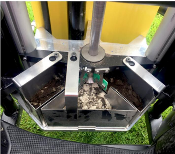
*Die drei Sammelbehälter für die Bodenproben. Eine einheitliche Bodensäule wird präzise geteilt und in die drei Sammelbehälter gefüllt.*
