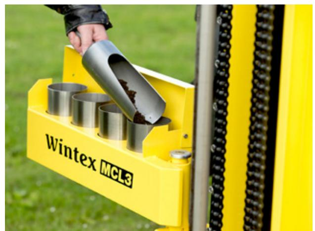
*Die Bodenprobe wird per Hand in die Sammelbehälter gefüllt. Das nötige Werkzeug (Schaufel und Schaber) wird mitgeliefert.*
