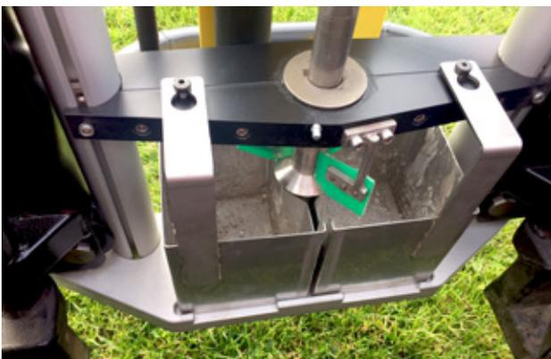
*Die Sammelbehälter für die Bodenproben mit den Abstreiferblättern, die den Bohrstock nach jedem Arbeitsgang völlig entleeren, bevor er erneut in den Boden geht.*
