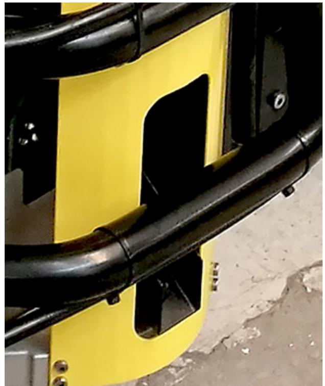
*Stößt das Wintex 2000 auf ein Hindernis oder wird eine unvollständige Bodenprobe entnommen, wird diese nicht in die Sammelbehälter gefüllt, sondern durch diesen Trichter ausgeworfen.*
