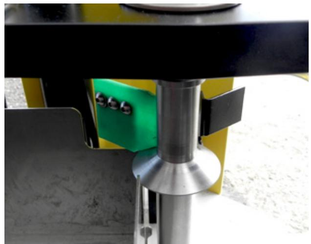
*Die Abstreiferblätter entleeren den Bohrstock vollständig und sorgen dafür, dass die Erde in den Sammelbehälter gefüllt wird.*
