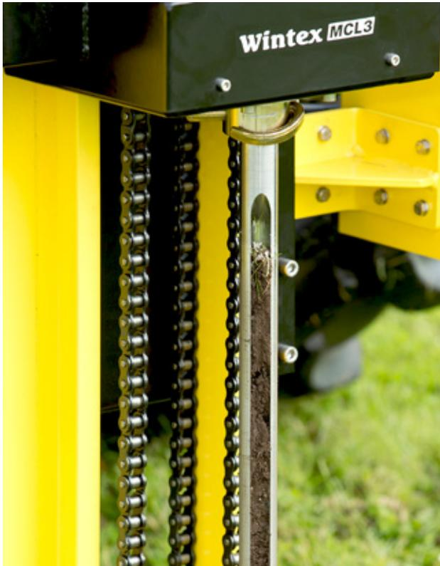
*Das Wintex MCL3 entnimmt eine einheitliche Bodensäule bis zu 120 oder 200 cm.*
