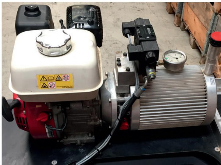
Die Hydraulik ist speziell für das **WINTEX 1000** angefertigt und ist an einen robusten und kräftigen Honda GX160 Motor angebaut.
