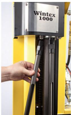
Der Bohrstock kann leicht ausgetauscht werden, auch bei der Arbeit auf dem Feld. Die Gegenmutter muss nur gelöst und ein neuer Bohrstock eingesetzt werden.
