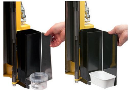
Das **WINTEX 1000** ist mit verschiedenen Sammelbehältern lieferbar, die zu den meisten Probenbehältern passen oder mit einem Sammelbehälter, von dem die Erde direkt in eine Tüte gefüllt wird.
