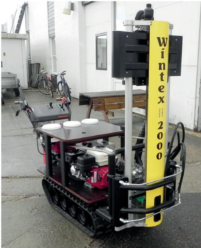
Das **WINTEX 2000** ist ein effektives und kräftiges vollautomatisches Bodenprobengerät. Es ist bedienungsfreundlich, leicht anzuwenden und erfordert nur minimale Wartung. Alle Funktionen werden bequem vom Fahrersitz ausgeführt.
