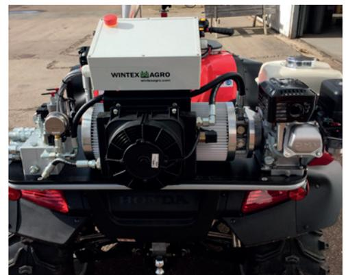
Der spezialangefertigte Öltank ist aus Aluminium. Die Oberfläche des Tanks ist wellenförmig und damit drei Mal so groß ist wie eine glatte Oberfläche. Durch das Aluminium und die wellenförmige Oberfläche ist die Kühlkapazität des Aluminiumtanks 12 Mal so groß wie die Kühlkapazität eines traditionellen Öltanks. Somit wird das Hydrauliköl optimal gekühlt.
