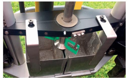
Die Erde aus unterschiedlichen Schichten wird automatisch in zwei Sammelbehälter gefüllt. Die Bodenproben werden präzise geteilt.
