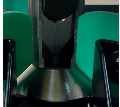
Der Auswerfer passt genau zum inneren Durchmesser des Bohrstocks. Die Abstreiferblätter sorgen dafür, dass der Bohrstock jedes Mal völlig entleert wird, bevor er erneut in den Boden geht.
