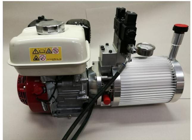
Der spezialangefertigte Öltank ist aus Aluminium hergestellt. Seine Oberfläche ist wellenförmig und damit drei Mal so groß wie eine glatte Oberfläche. Durch das Aluminium und die wellenförmige Oberfläche ist die Kühlkapazität 12 Mal so groß wie die eines traditionellen Öltanks und kühlt das Öl optimal.
