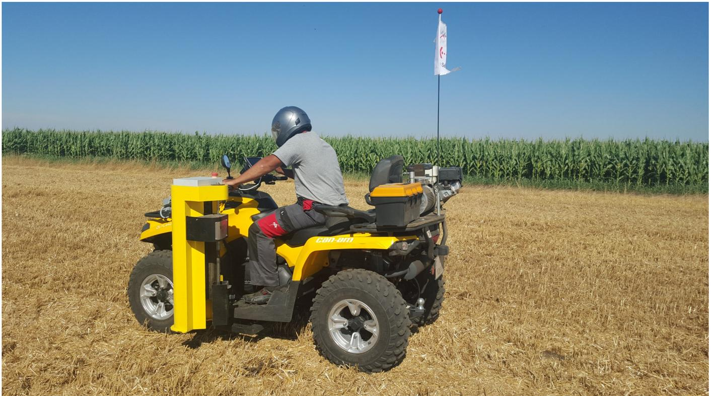
Das **WINTEX 1000** ist ein effizientes und kräftiges Bodenprobengerät für Bodenproben bis zu 25 cm. Es ist bedienungsfreundlich, erfordert nur minimale Wartung und ist leicht zu handhaben. Alle Funktionen werden bequem vom Fahrersitz ausgeführt.
