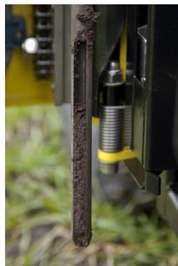
Der Bohrstock kann leicht ausgewechselt werden, auch bei der Arbeit auf dem Feld. Die Gegenmutter muss nur gelöst und ein neuer Bohrstock eingesetzt werden.
