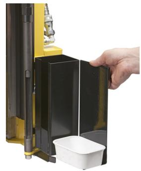
Das WINTEX 1000 ist mit verschiedenen Sammelbehältern lieferbar, die zu den meisten Probenbehältern passen, oder mit einem Sammelbehälter, von dem die Erde direkt in eine Tüte gefüllt wird.
