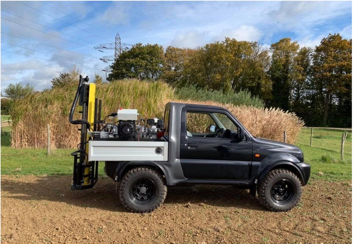
Das **WINTEX 3000** ist ein effizientes und robustes automatisches Bodenprobengerät. Es ist bedienungsfreundlich, leicht anzuwenden und erfordert nur minimale Wartung. Alle Funktionen werden bequem vom Fahrersitz ausgeführt.
