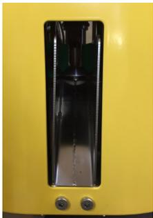
Wenn das **WINTEX 3000** auf ein Hindernis stößt oder der Probenvorgang unterbrochen und daher eine unvollständige Probe entnommen wird, wird diese durch einen Trichter verworfen und nicht in die Sammelbehälter gefüllt.
