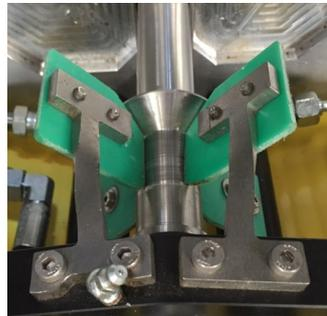
Der Auswerfer passt genau zum inneren Durchmesser des Bohrstocks. Die Abstreiferblätter sorgen dafür, dass der Bohrstock jedes Mal völlig entleert wird, bevor er erneut in den Boden geht.
