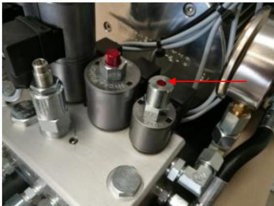
Das Überdruckventil sitzt unter der roten Kappe und dient dazu, den Hauptdruck einzustellen. Der Hauptdruck ist auf 120 Bar voreingestellt und darf nur nach schriftlicher Zulassung mit Wintex Agro geändert werden..
