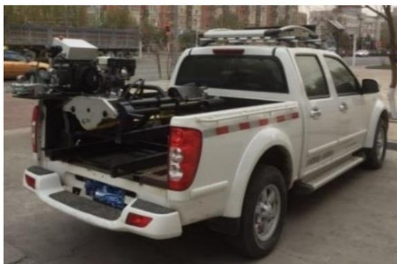
Abhängig von der Größe des Pickups müssen Sie einen geeigneten Platz für das Hydraulikaggregat finden. Sie können das Bodenprobengerät auch auf eine Seite des Bettes schieben, um Platz für das Hydraulikaggregat zu schaffen.
