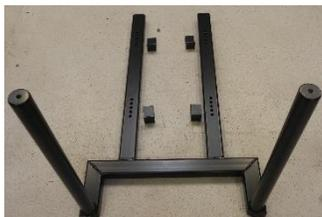
Bitte beachten Sie, dass möglicherweise neue Löcher für die Halterungen gebohrt oder die Halterungen an das Fahrgestell des Fahrzeugs geschweißt werden müssen. Der Anbaurahmen muss sich 20 cm über dem Boden befinden. Auf Wunsch kann das WINTEX mit 10 cm längeren Zylindern geliefert werden, wodurch der Anbaurahmen bis zu 30 cm über dem Boden montiert werden kann.
