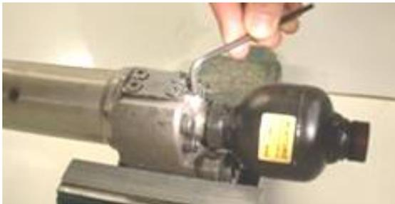
Lösen Sie mit einem 4 mm Inbusschlüssel die Schrauben. Bitte beachten Sie, dass sich in jedem Loch zwei Schrauben befinden.
