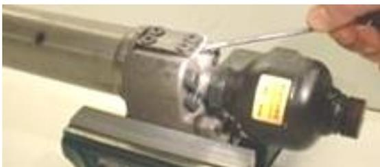
Benutzen Sie einen 3 mm Inbusschlüssel. Vergewissern Sie sich, dass das Werkzeug in gutem Zustand und der Bolzen sauber ist.
