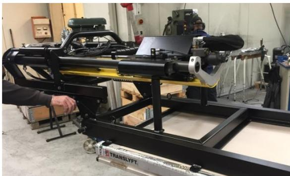
Der kippbare Teil des Rahmens ist mit Federsperrschrauben verriegelt. Sie können den Winkel so einstellen, dass Sie das Bodenprobengerät in einem 90-Grad-Winkel zum Boden neigen können.
