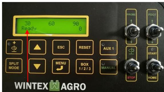
Die zweite Zeile des Displays zeigt den aktivierten Betriebsmodus an. Wenn sich das Bodenprobengerät in der Position „HOME“ befindet, zeigt das Display den Modus „Ready“ an.
