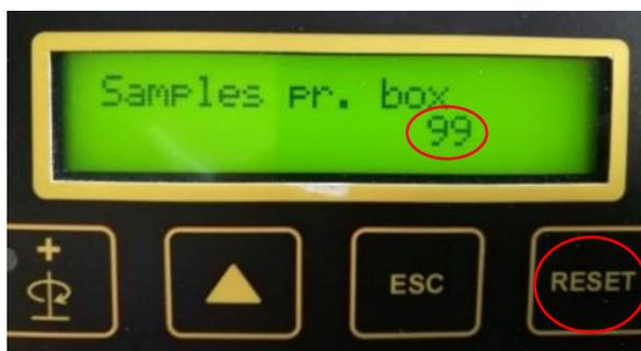
Unten rechts auf dem Display befindet sich ein Zähler, der die Einstiche für jede Bodenprobe registriert. Der Zähler kann wieder auf 0 gestellt werden, indem man auf die „RESET“-Taste drückt. Zugang zu dieser Funktion bekommt man dadurch, dass man auf die Pfeiltaste nach unten drückt, wenn man sich auf dem Startdisplay befindet.
