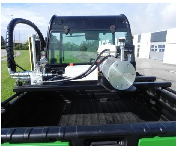
Ölpumpe und Honda GX 200-Motor an einem John Deere 855D
