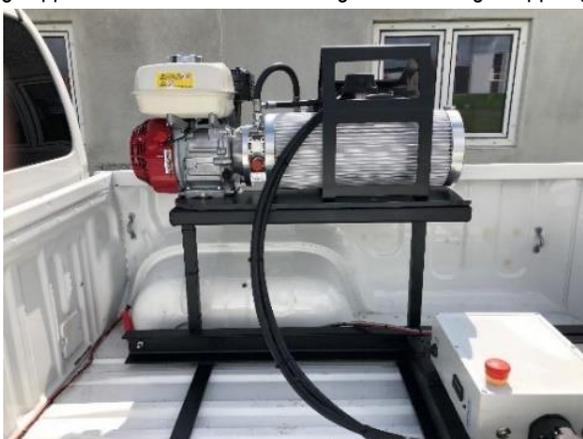
Der Rahmen muss in diesen sechs Befestigungspunkte mit Bolzen montiert werden. Möglicherweise müssen große Unterlegscheiben unter den Rahmen gelegt werden, um die Ladefläche zu verstärken.
