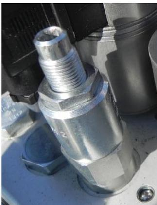
Abhängig vom Gewicht des Fahrzeuges und der Bodenart muss der Druck zwischen 10 und 30 Bar liegen. Lesen Sie den Druck an diesem Manometer ab, das nur den Druck des Bohrstocks anzeigt während er sich nach nach unten bewegt.
