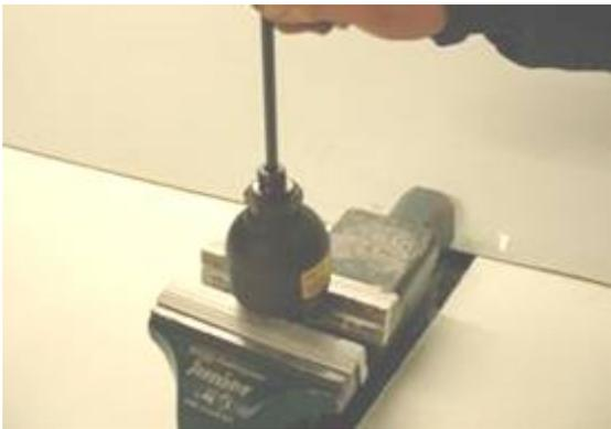
Lösen Sie die Ladeschraube mit einem 6 mm Inbusschlüssel. Wenn der Akkumulator funktioniert, können Sie ein pfeifendes Geräusch von dem Stickstoff hören. In diesem Fall muss der Akkumulator nur wieder mit Stickstoff aufgeladen werden. Wenn Sie kein pfeifendes Geräusch hören, ist die Membran höchstwahrscheinlich defekt und muss ausgetauscht werden.
