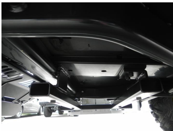
Estrutura da moldura montada abaixo do veículo
