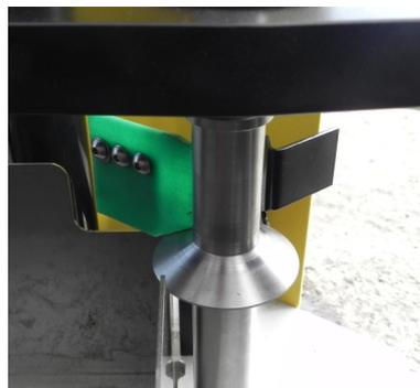
O raspador se ajusta ao diâmetro interno da sonda com precisão e as lâminas raspadoras garantem que a sonda seja totalmente esvaziada antes de entrar no solo novamente.
