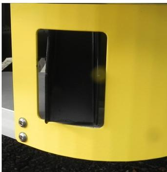
Se o WINTEX 1000s encontrar obstáculos ou for interrompido durante o processo de amostragem e, portanto, colher uma amostra será descartada através de um funil e não será despejada nas caixas de solo.
