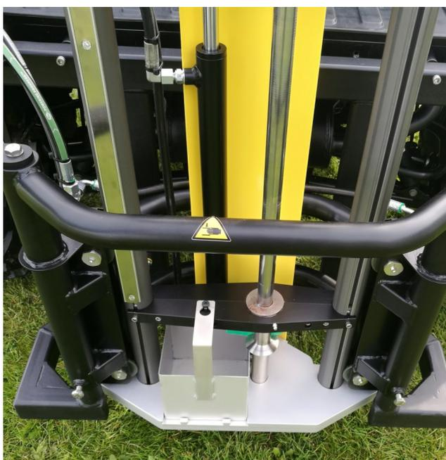
A montagem do **WINTEX 1000s** em uma estrutura invertida garante fácil acesso à caixa de solo.
