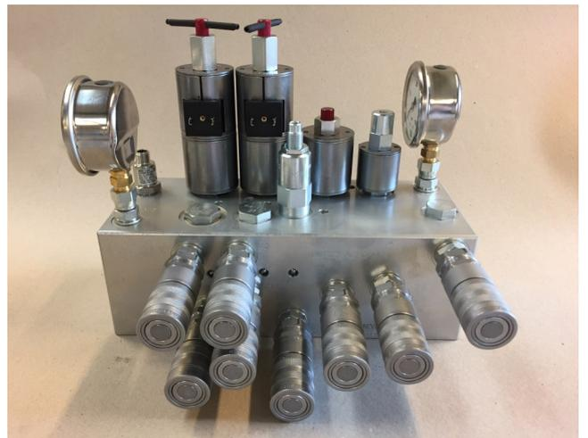
Todas as funções são conduzidas pelo bloco de distribuição personalizado. O sistema hidráulico é de construção simples, o que torna a manutenção fácil e descomplicada.
