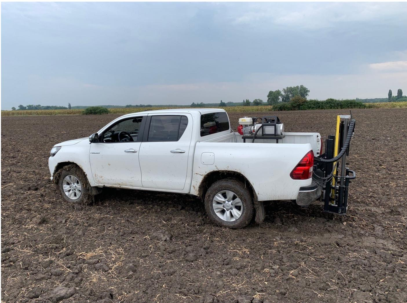
O **WINTEX 1000s** é um amostrador de solo automático eficiente e robusto. É fácil de usar e requer apenas manutenção mínima. Todas as funções são executadas confortavelmente a partir do banco do motorista.
