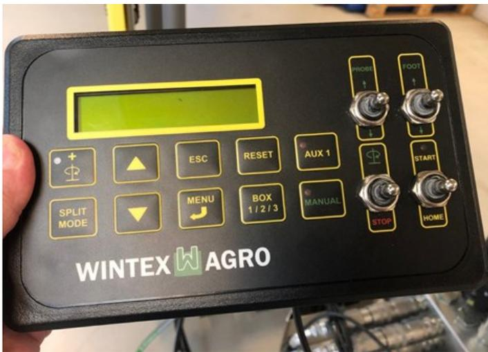
Todas as ações podem ser realizadas a partir do sistema de controle. Pré-configurações como profundidade, sondas e camadas por amostra, bem como a escolha da caixa de solo, podem ser inseridas de forma rápida e fácil no sistema de controle.
