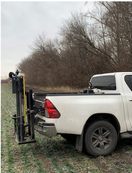
O WINTEX 2000 pode ser montado em uma ampla gama de veículos de transporte, por exemplo quadriciclos, Ranger, tratores, pick-ups, vans de baixa tonelada e reboques.
