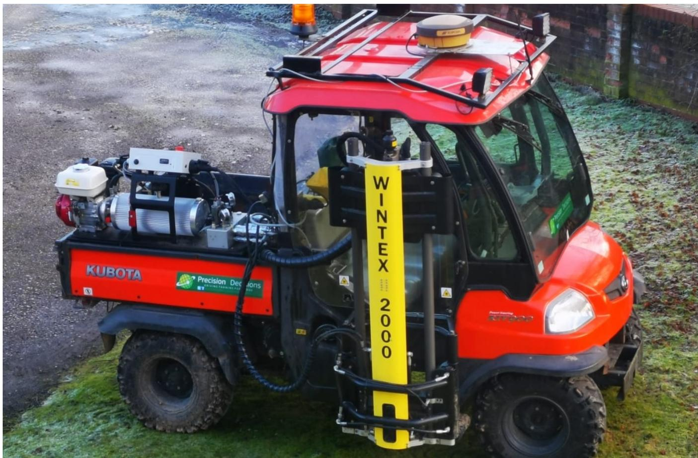
O **WINTEX 2000** é um amostrador de solo automático eficiente e robusto. É fácil de usar e requer apenas manutenção mínima. Todas as funções são executadas confortavelmente a partir do banco do motorista.
