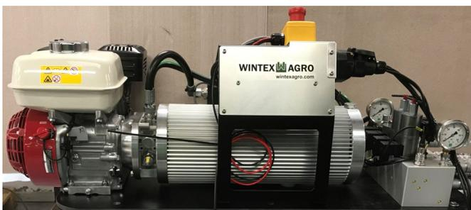
O tanque de óleo feito sob medida é feito de alumínio. Tem uma superfície com nervuras, o que significa que a área do tanque de óleo é três vezes maior do que uma superfície plana. Devido ao alumínio e à superfície com nervuras, a capacidade de resfriamento é 12 vezes maior do que a capacidade de resfriamento de um tanque de óleo tradicional, garantindo o resfriamento ideal do óleo hidráulico.
