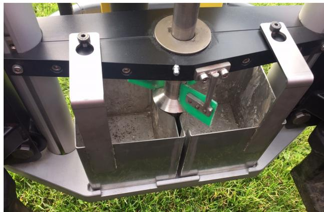
O solo de diferentes camadas é automaticamente preenchido nas caixas de solo. A divisão das amostras é realizada com grande precisão.
