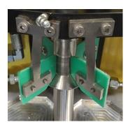
O raspador se ajusta ao diâmetro interno da sonda com precisão e as lâminas raspadoras garantem que a sonda seja totalmente esvaziada antes de entrar no solo novamente.
