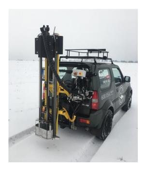
O WINTEX 3000 pode ser montado em uma ampla gama de veículos de tranporte, por exemplo quadriciclos, Ranger, tratores, pick-ups, vans de baixa tonelada e reboques.
