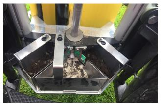
O solo de diferentes camadas é automaticamente preenchido nas caixas de solo. A divisão das amostras é realizada com grande precisão.
