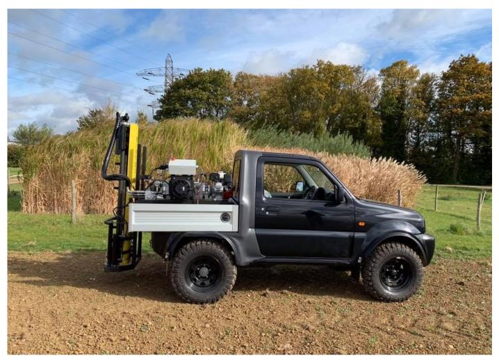
O **WINTEX 3000** é um amostrador de solo automático eficiente e robusto . È fácil de usar e requer apenas manuntenção mínima. Todas as funções são executadas confortavelmente a partir do banco do motorista.
