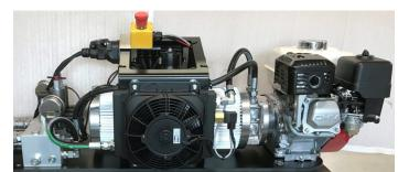
O tanque de óleo feito sob medida é feito de alumínio. Tem uma superfície com nervuras, o que significa que a área do tanque de óleo é três vezes maior do que uma superfície plana. Devido ao alumínio e à superfície com nervuras, a capacidade de refriamento é 12 vezes maior do que a capacidade de resfriamento de um tanque de óleo tradicional, garantindo o resfriamento ideal do óleo hidráulico.
