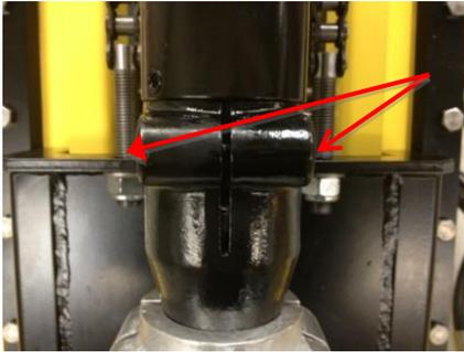
Spannen Sie die Ketten, indem Sie die Muttern anziehen.
