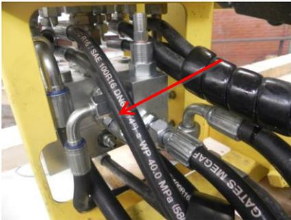
Lösen Sie zum Einstellen des Druckes die Inbusschraube.
