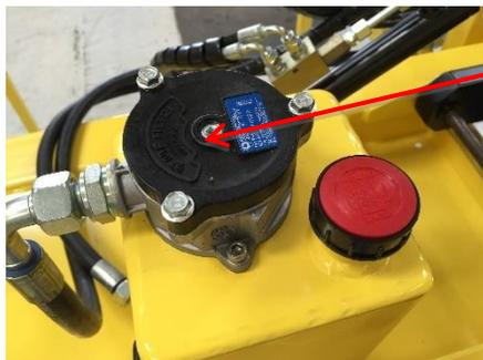
Nach 50-100 Betriebsstunden muss der Rücklaufilter ausgetauscht werden.
