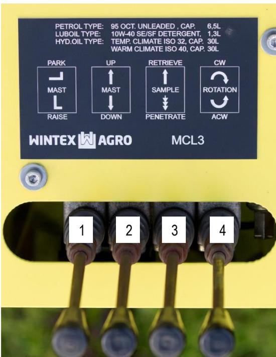
Alle Funktionen werden hydraulisch über das Kontrollpanel ausgeführt. Es gibt vier verschiedene Funktionen:
