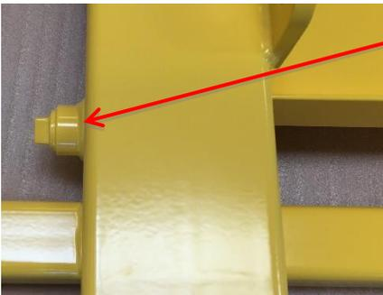
Entfernen Sie die beiden Ablassschrauben (eine an jeder Seite) und entleeren Sie den Öltank.
