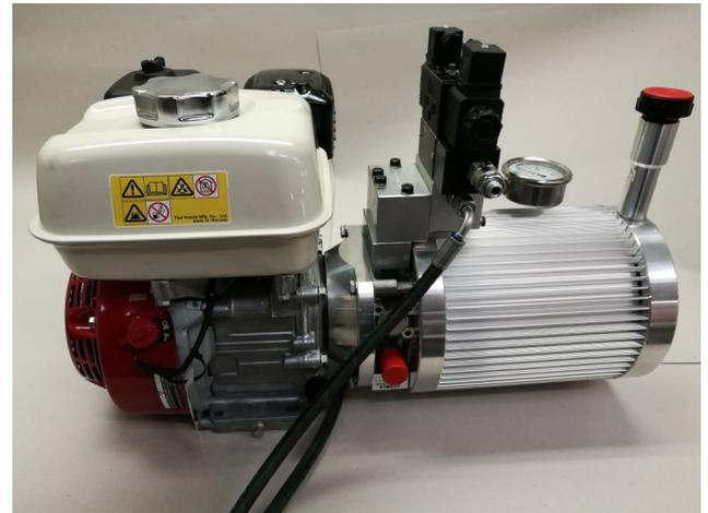
Der spezialanfertigte Öltank ist aus Aluminium hergestellt. Seine Oberfläche ist wellenförmig und damit drei Mal so groß wie eine glatte Oberfläche. Durch das Aluminium und die wellenförmige Oberfläche ist die Kühlkapazität 12 Mal so groß wie die eines traditionellen Öltanks und kühlt das Öl optimal.
