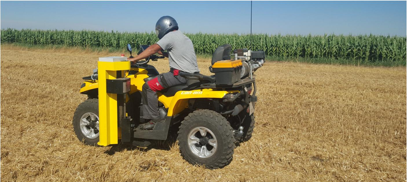
Das **WINTEX 1000** ist ein effizientes und kräftiges Bodenprobengerät für Bodenproben bis zu 25 cm. Es ist bedienungsfreundlich, erfordert nur minimale Wartung und ist leicht zu handhaben. Alle Funktionen werden bequem vom Fahrersitz ausgeführt.
