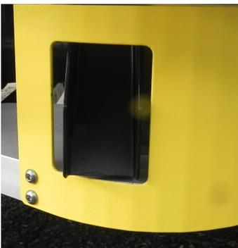
Wenn das **WINTEX 1000s** auf ein Hindernis stößt oder der Probenvorgang unterbrochen und daher eine unvollständige Probe entnommen wird, wird diese durch einen Trichter verworfen und nicht in den Sammelbehälter gefüllt.
