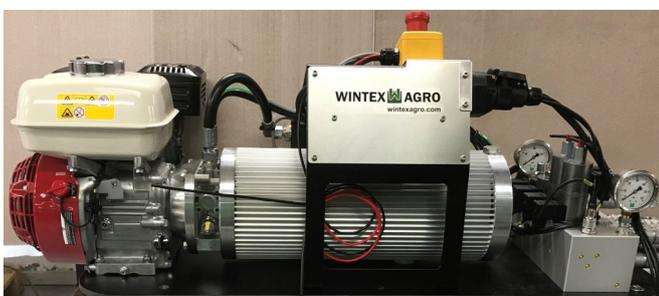
Der spezialangefertigte Öltank ist aus Aluminium hergestellt. Seine Oberfläche ist wellenförmig und damit drei Mal so groß wie eine glatte Oberfläche. Durch das Aluminium und die wellenförmige Oberfläche ist die Kühlkapazität 12 Mal so groß wie die eines traditionellen Öltanks und kühlt das Öl optimal.
