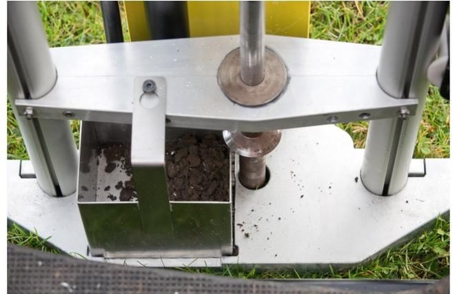
Die entnommene Erde wird direkt in den Sammelbehälter gefüllt und kann von da aus in Becher oder Tüten für den Versand ins Labor gefüllt werden.
