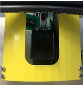
Wenn das **WINTEX 2000** auf ein Hindernis stößt oder der Probenvorgang unterbrochen und daher eine unvollständige Probe entnommen wird, wird diese durch einen Trichter verworfen und nicht in den Sammelbehälter gefüllt.
