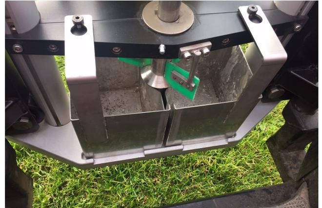
Die Bodenproben werden präzise geteilt und die Erde aus den unterschiedlichen Schichten wird automatisch in zwei Sammelbehälter gefüllt.
