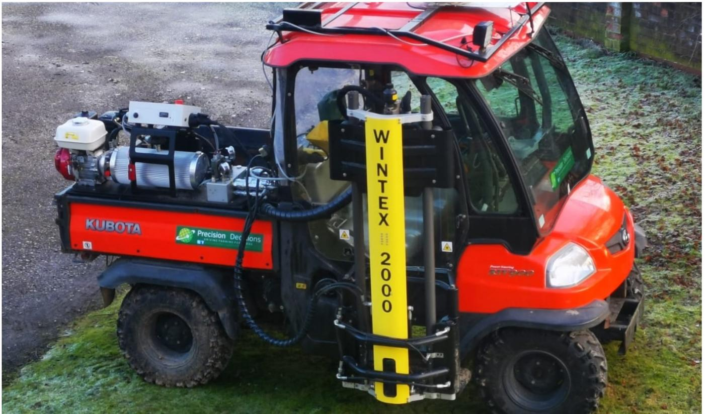
Das **WINTEX 2000** ist ein effizientes und robustes automatisches Bodenprobengerät. Es ist bedienungsfreundlich, leicht anzuwenden und erfordert nur minimale Wartung. Alle Funktionen werden bequem vom Fahrersitz ausgeführt.
