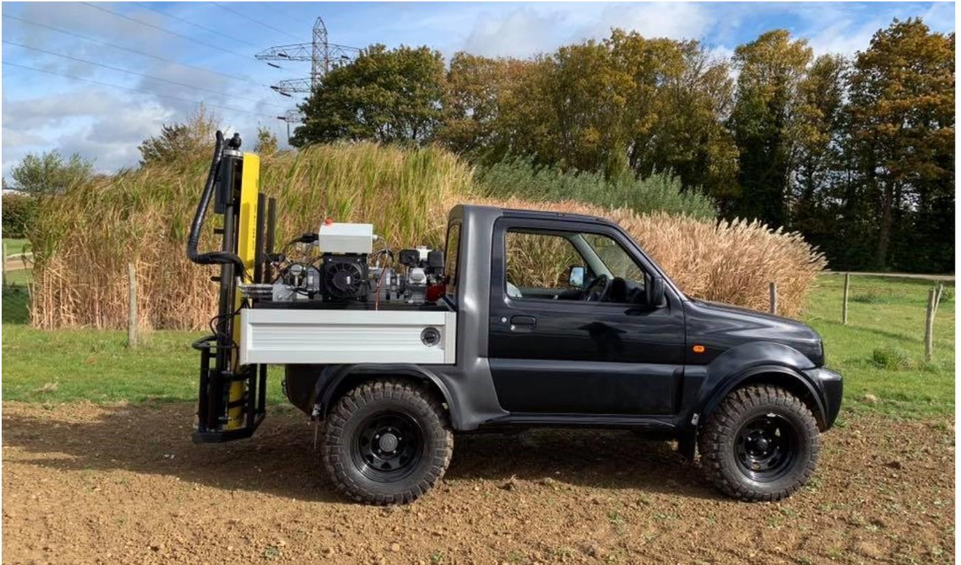
Das **WINTEX 3000** ist ein effizientes und robustes automatisches Bodenprobengerät. Es ist bedienungsfreundlich, leicht anzuwenden und erfordert nur minimale Wartung. Alle Funktionen werden bequem vom Fahrersitz ausgeführt.
