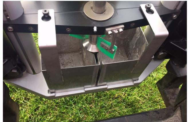
Die Bodenproben werden präzise geteilt und die Erde aus den unterschiedlichen Schichten wird automatisch in die Sammelbehälter gefüllt.
