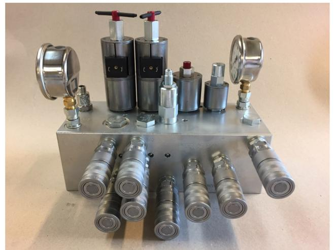
Alle Funktionen werden von dem spezialangefertigten Verteilerblock ausgeführt. Das Hydrauliksystem ist einfach konzipiert, so dass es leicht und unkompliziert zu warten ist.
