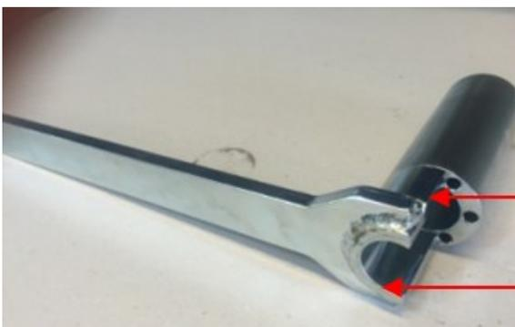
Entfernen Sie den Bohrstockhalter mit dem Spezialschlüssel, der zusammen mit dem Bodenprobengerät geliefert wurde. Der Bohrstock kann jetzt entfernt werden.
