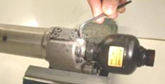
Benutzen Sie einen 4 mm Inbusschlüssel. Vergewissern Sie sich, dass er in einem gutem Zustand ist und dass der Bolzen sauber ist.
