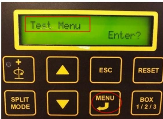
Wenn Sie auf die **"MENU"** -Taste drücken, erhalten Sie Zugang zum Testmenü. Zuerst zeigt das Display "Setup Menu" an. Drücken Sie nun auf die Taste mit dem Pfeil nach unten und das "Test Menu" erscheint auf dem Display.
