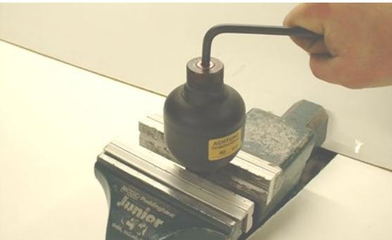
Lösen Sie die Ladeschraube mit einem 6 mm Inbusschlüssel. Wenn der Druckspeicher funktioniert, können Sie ein pfeifendes Geräusch von dem Stickstoff hören. In diesem Fall muss der Druckspeicher nur wieder mit Stickstoff aufgeladen werden. Wenn Sie kein pfeifendes Geräusch hören, ist die Membran höchstwahrscheinlich defekt und muss ausgetauscht werden.
