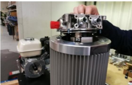
Setzen Sie einen neuen Filter ein. Reinigen Sie den Tank gründlich.
