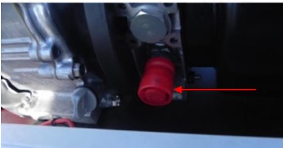
Das Überdruckventil sitzt unter der roten Kappe und dient dazu, den Hauptdruck einzustellen. Der Hauptdruck ist auf 120 Bar voreingestellt und darf nur nach schriftlicher Zulassung von Wintex Agro geändert werden.
