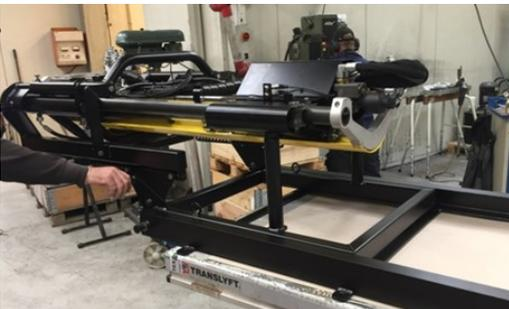
Wenn das Bodenprobengerät angebaut ist, müssen Sie die Federsperrbolzen am Rahmen lösen und den inneren Rahmen nach hinten ziehen. Wenn Sie den Anschlag erreichen, stellen Sie sicher, dass die Federsperrbolzen in den Löchern einrasten, um das Bodenprobengerät zu sichern. Lösen Sie dann die Federsperrbolzen des Kipprahmens und heben Sie das Bodenprobengerät von Hand in die Arbeitsposition. Achten Sie darauf, dass die Verriegelungsbolzen einrasten.
