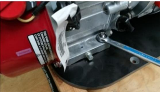
Entfernen Sie die Bolzen am Motor und am Tank.
