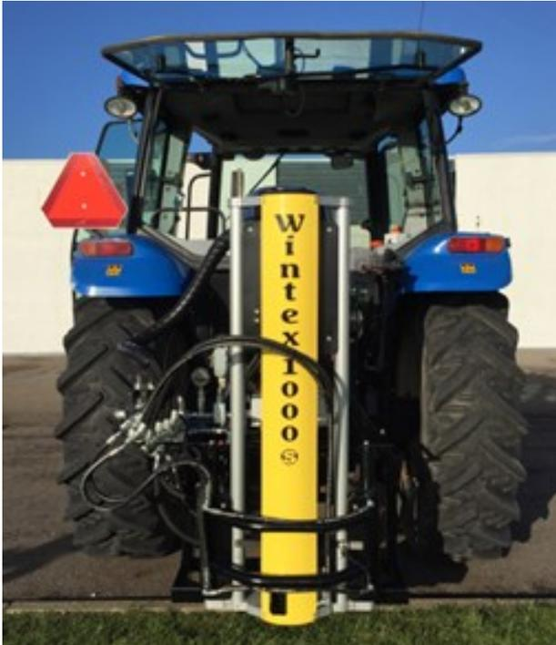
Das Bodenprobengerät wird mit einer 12 V Steckdose geliefert, die an den 12 V Stecker des Traktors angeschlossen werden muss.
