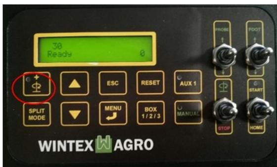
Drücken Sie auf die Taste mit dem Rotationssymbol, um eine extra Rotation auszuführen. Dies kann in einigen Bodenarten vorteilhaft sein.
