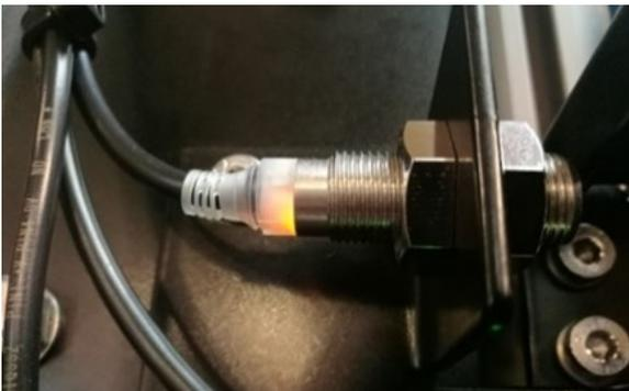
Wenn das Licht am Sensor orange leuchtet, funktioniert der Sensor, aber entweder stimmt der Abstand nicht oder der Sensor befindet sich an der Kante von einem der Löcher in der Sensorschiene. Wird der Sensor zu weit von der Schiene entfernt, leuchtet das Licht ebenfalls orange. Der Sensor gibt immer noch das richtige Signal, aber es kann sein, dass falsche Messwerte und dadurch eine falsche Höhe angezeigt werden.
