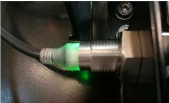
Wenn ein Sensor richtig eingestellt ist und sich vor der Sensorschiene befindet, leuchtet das Licht am Sensor grün. Das bedeutet, dass der Sensor funktioniert.
