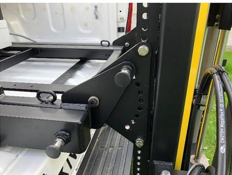
Abhängig von der Größe des Pickups müssen Sie einen geeigneten Platz für das Hydraulikaggregat finden. Sie können das Bodenprobengerät auch auf eine Seite des Bettes schieben, um Platz für das Hydraulikaggregat zu schaffen.
