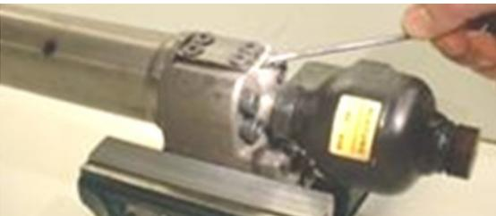
Lösen Sie mit dem 4 mm Inbusschlüssel vorsichtig die Schrauben. Beachten Sie, dass sich in jedem Loch zwei Schrauben befinden.
