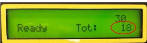
Auch die Gesamtmenge der ausgeführten Einstiche wird registriert und auf dem Display angezeigt. Dieser Wert kann nicht zurückgesetzt werden.
