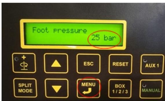
Wenn das Bodenprobengerät nicht fest auf den Boden gedrückt ist, muss der Druck des Fußes mit Hilfe der **MENU**- und der Pfeiltasten, wie oben angegeben, reguliert werden.
