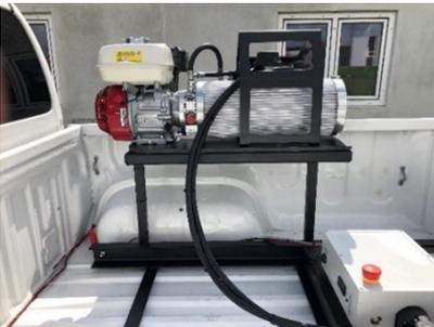
Der Rahmen muss an diesen sechs Befestigungspunkten mit Bolzen montiert werden. Evtl. müssen große Unterlegscheiben unter den Rahmen gelegt werden, um die Ladefläche zu verstärken.
