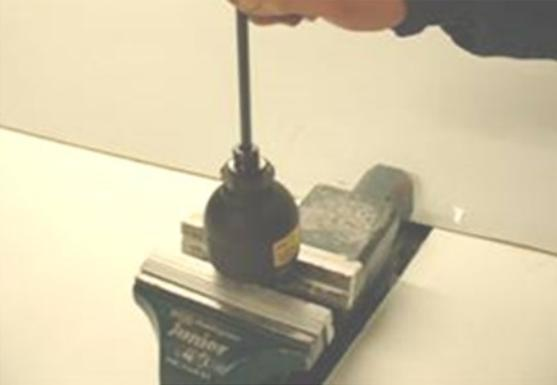
Stecken Sie einen langen Stab in das Loch im Druckspeicher, um zu kontrollieren, dass Druck auf dem Druckspeicher ist. Wenn sich die Membran ziemlich leicht bewegt lässt, muss der Druckspeicher entweder mit Stickstoff aufgeladen werden oder die Membran ist defekt. Sollte die Membran defekt sein, muss der Druckspeicher ausgetauscht werden.
