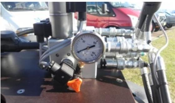
Abhängig vom Gewicht des Fahrzeuges und der Bodenart muss der Druck zwischen 10 und 30 Bar liegen. Lesen Sie den Druck an diesem Manometer ab, das nur den Druck des Bohrstocks anzeigt während er sich nach unten bewegt.
