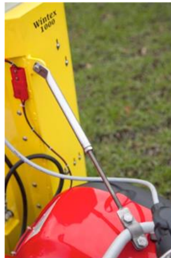
Das Kabel mit dem roten Stecker muss an die Batterie des ATVs angeschlossen werden: rot +, schwarz -.
