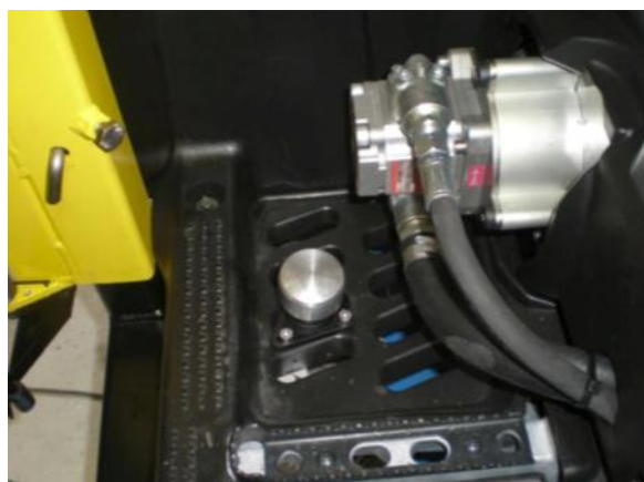
Der Anbaurahmen muss so dicht wie möglich an dem ATV befestigt werden.
